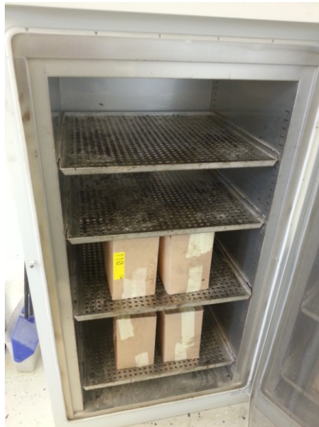
Figur 5: Uppvärmning av asfaltmassa i varmluftugn.
