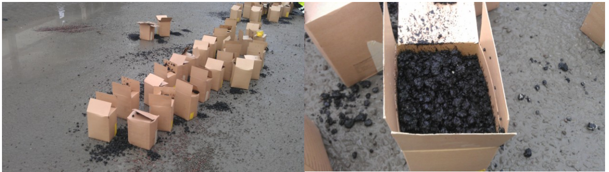
Figur 4: Avhämtning av asfaltmassa tillverkad på Skanskas asfaltverk i Södertälje - ABS 16 70/100.
