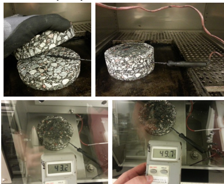
Figur 17: Kontroll av temperaturen inuti provkropp.
