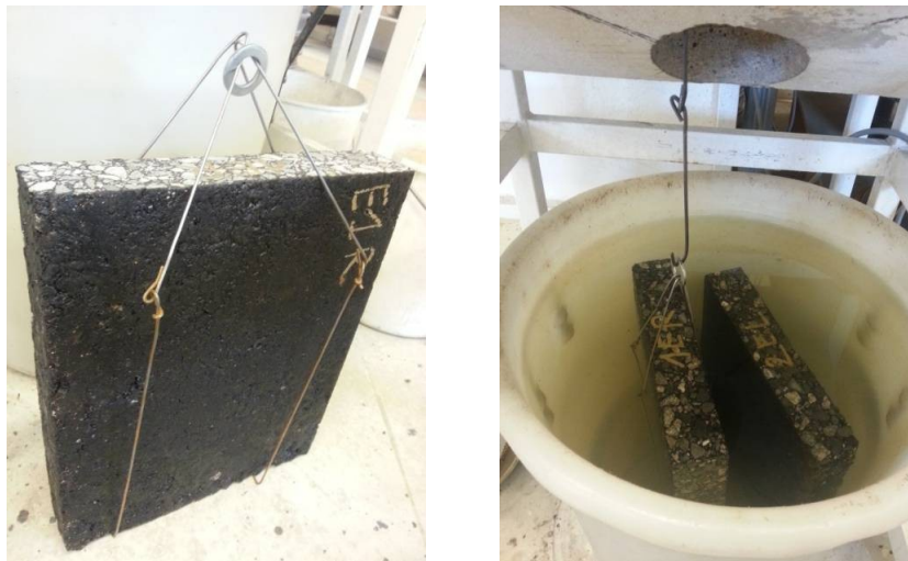
Figur 8: Skrymdensitet enligt EN 12697-6, procedur B i vatten.
